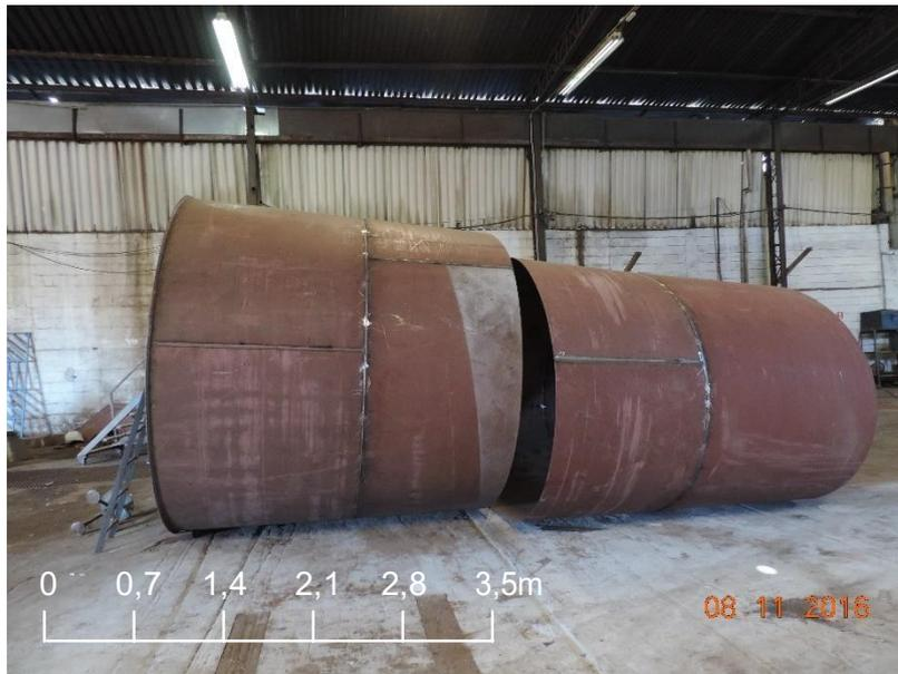
FIGURA 14: Acoplamento horizontal dos anéis.
