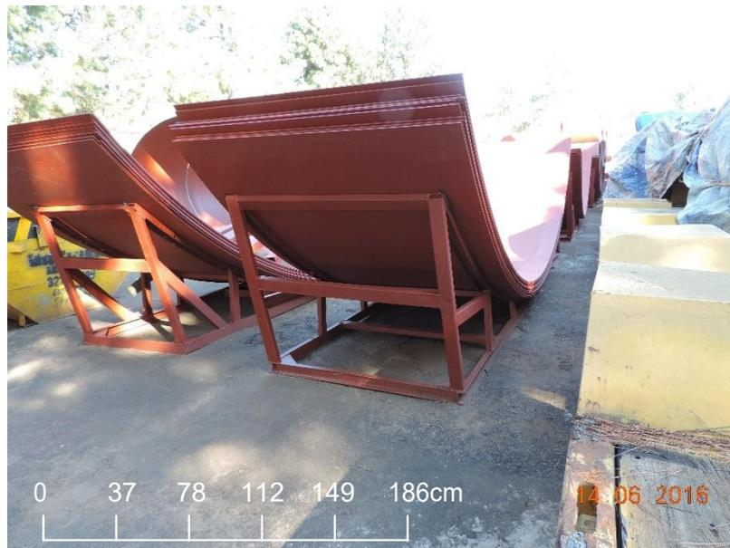
FIGURA 11: Condicionamento das chapas calandradas.
