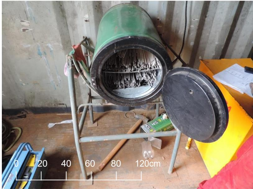
FIGURA 21: Armazenamento correto de eletrodos.
